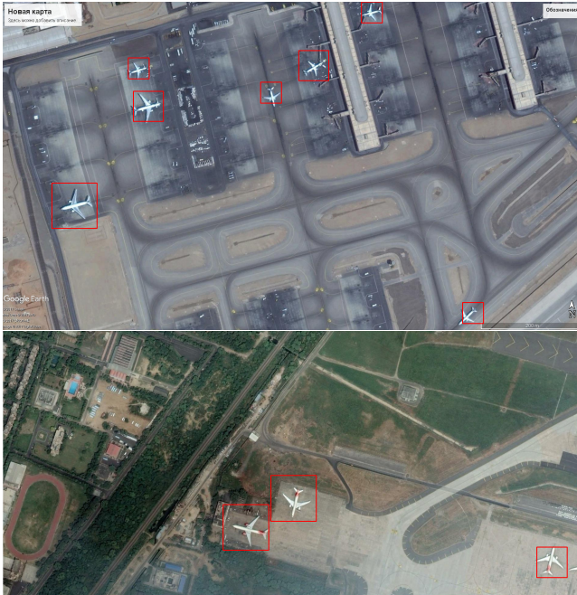
Рис. 7. Результат поиска объектов с помощью нейронной сети и алгоритма фильтрации координатных прямоугольников
