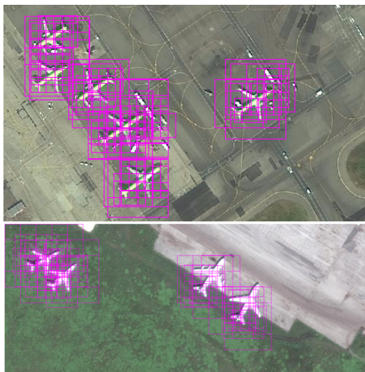
Рис. 4. Примеры результата поиска самолетов с помощью скользящих масок и нейронной сети
