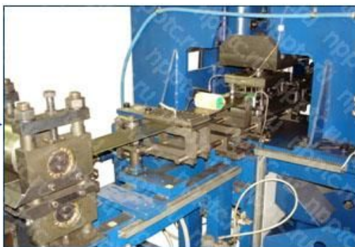
Агрегатный блок пневматических прессов портального типа со специальной оснасткой
