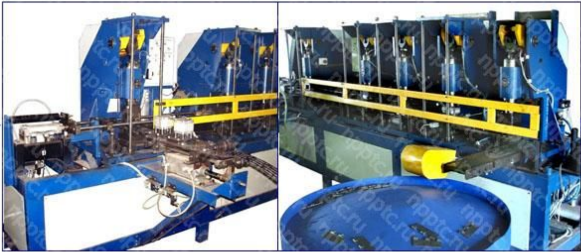
Агрегатный блок пневматических прессов для завершающих технологических операций (за 1 рабочий цикл производятся детали "Левая полупетля" и "Правая полупетля")
