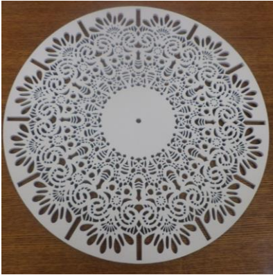
Декоративный циферблат Лазерная резка + покраска Фанера 6мм
