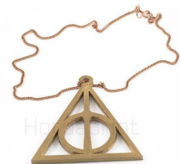
Декоративный кулон «Дары смерти» Пластик – ABS Время печати – 12 минут Обработка: Покраска
