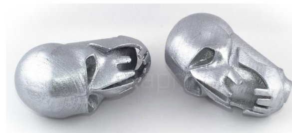
Насадка на рычаг коробки передач в стиле Mad Max Пластик – ABS, PETG Время печати - 6 часов каждый Обработка: Ошкуривание, покраска
