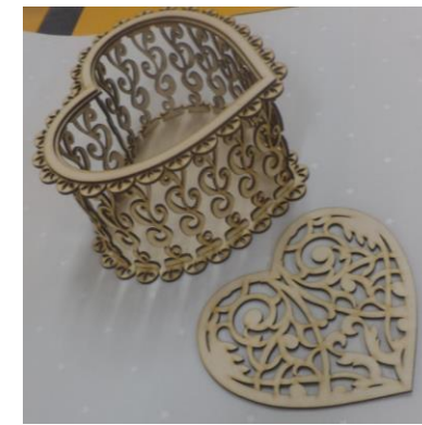
Подарочная Трехмерная шкатулка для хранения Лазерная резка Фанера 3мм
