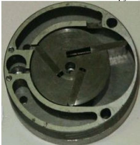
Рис. 9. Узел сжатия РДК со снятой щекой
